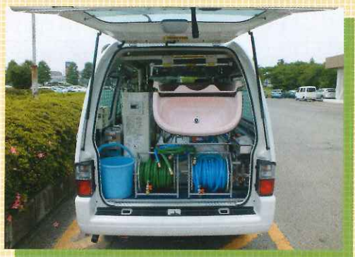
▲ 入浴車の内部にはボイラーをはじめ浴槽、ホースなどの必要備品が隙間なく積み込まれています。
